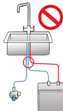
**Geeignet für druckresistente Durchlauferhitzer**
